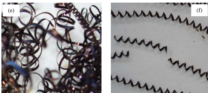
Figura 3 - Cavacos obtidos nos ensaios 5 (e) e 6 (f).
