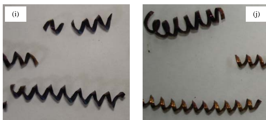
Figura 5 - Cavacos obtidos nos ensaios 9 (i) e 10 (j).
