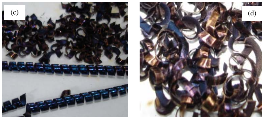
Figura 2 - Cavacos obtidos nos ensaios 3 (c) e 4 (d).
