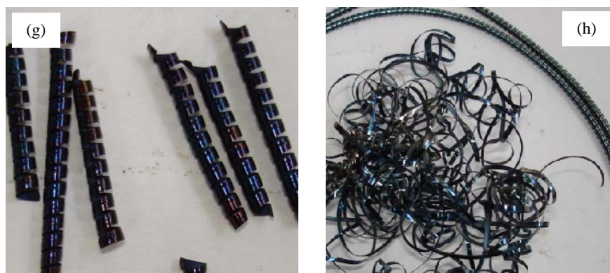
Figura 4 - Cavacos obtidos nos ensaios 7 (g) e 8 (h).
